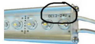
LED listan käyttöjännite on merkitty plus johtimen viereen. Merkintää ei ole kaikissa malleissa.
